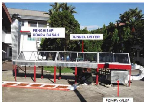
Gambar 2. Alat Pengering lorong berbantuan pompa kalor
