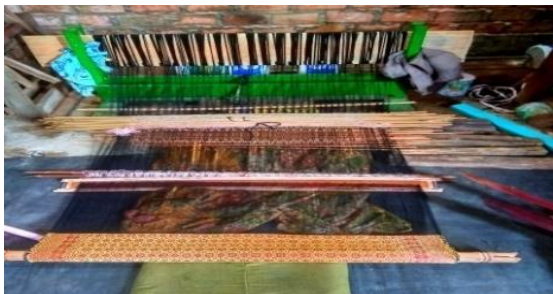
Gambar 6. Dayan Atau Alat Pembuat Kain Songket (Sumber: Pribadi, 2021)
