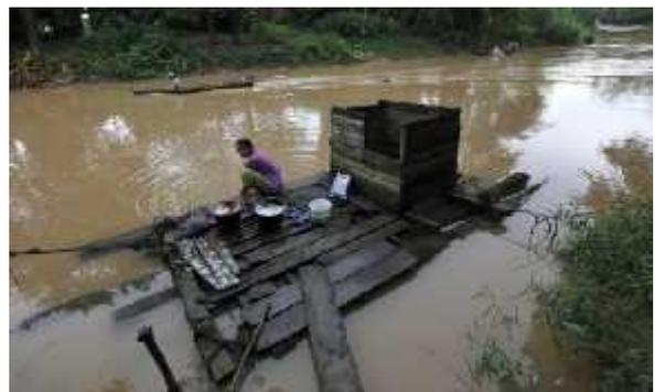
Setiap batang terdiri dari enam batang kayu yang disusun secara berjajar, yaitu tiga batang sebelah luar dan tiga batang sebelah dalam. Sedangkan batang yang terbuat dari bambu terdiri paling sedikit 20 batang bambu yang disusun berjajar.
