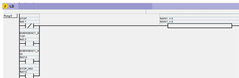
Gambar 9. Program PLC Penyimpanan Data Suhu Pada %MW.1
