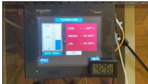
Gambar 12. Pengujian Perbandingan Suhu Termokopel Dengan Termometer Digital Dan HMI
