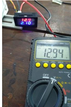
Gambar 16. Pengukuran tegangan baterai saat kondisi baterai lemah
