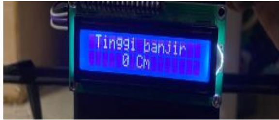
Gambar 14. Pengujian LCD Kondisi Sudah Terkoneksi
