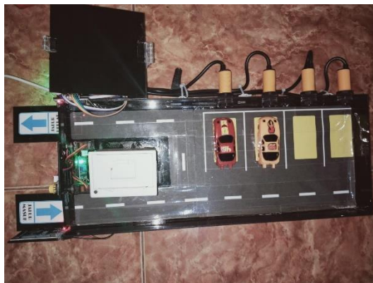
Gambar 19. Objek terdeteksi sensor
