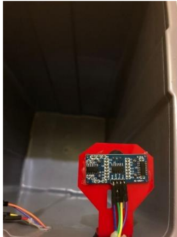
Gambar 10. Pemasangan Sensor Monitoring
