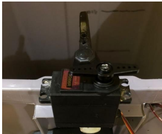
Gambar 11. Pemasangan Motor Servo
