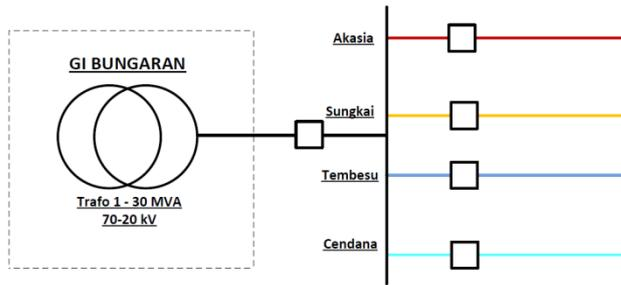
Gambar 3. Representasi Penyulang Pada Transformator 1, 30 MVA 70/20 kV Gardu Induk Bungaran Palembang
