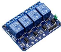
Gambar 5. Bentuk Fisik Relay
