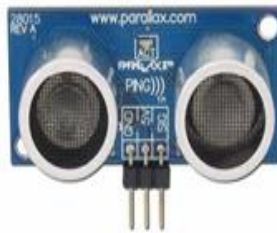
Gambar 3. Modul Sensor Ultrasonic (Lingga, 2006:23)
