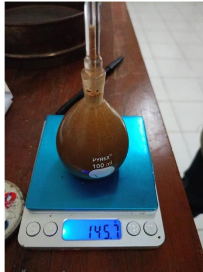
Gambar 8. Proses Perhitungan Berat Jenis Sedimen Dasar
