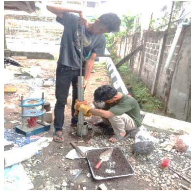
Gambar 5. Pengujian Pemadatan Tanah Standar di Laboratorium
