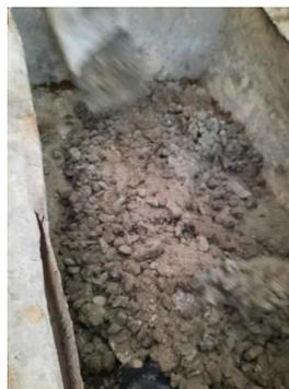
Gambar 3 Adukan Beton Rasio Na<sub>2</sub>SiO<sub>3</sub> dan NaOH 3.5 : 1
