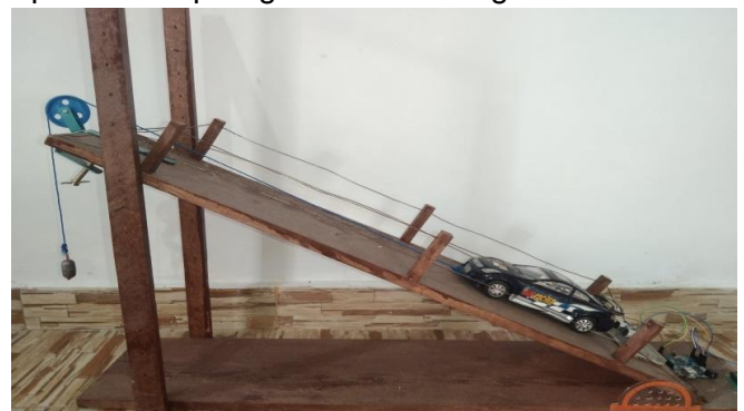
Gambar 1 Desain alat peraga pada bidang miring
