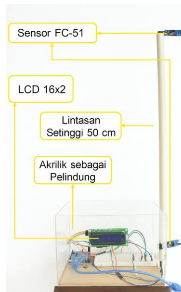
Gambar 5. Hasil Keseluruhan Perakitan Alat Praktikum Percepatan Gravitasi Digital
