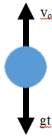
Gambar 1. Bola bisbol dilempar vertikal dengan kecepatan awal v_0 dipengaruhi oleh gaya gravitasi.
