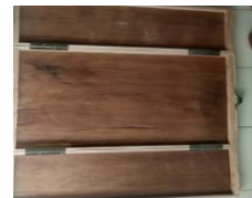
Gambar 5. Pemasangan engsel agar papan jumanji bisa dilipat
