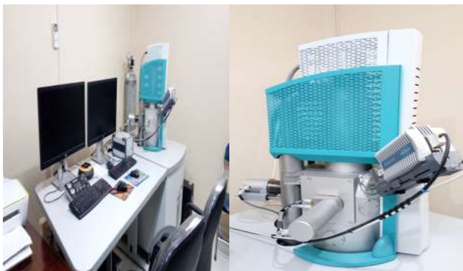
Gambar 1. Alat analisa SEM-EDX
