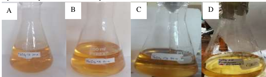
Gambar 1. Hasil Hidrolisis Variasi Waktu Pemanasan (A) 30, (B) 40, (C) 50, dan (D) 60 menit.
