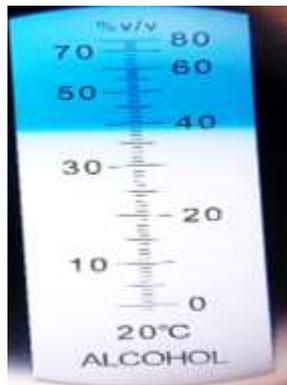
**Gambar 3.** Hasil Analisis Bioetanol menggunakan *Hand Refractometer*.
