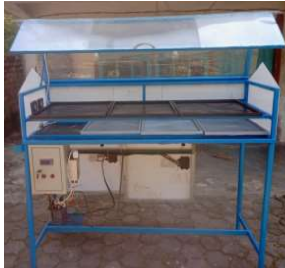
Gambar 6. Realisasi Alat Drying Chips sumber : Dokumen Pribadi Penulis (Desain Visio)
