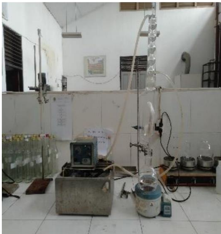
Gambar 2. Rangkaian Alat Penelitian Ekstraksi Minyak Biji Kemiri
