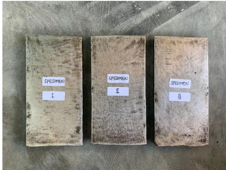
Gambar 1. Plat Kapal Yang Telah Dipotong Menjadi 3 (Tiga) Bagian
