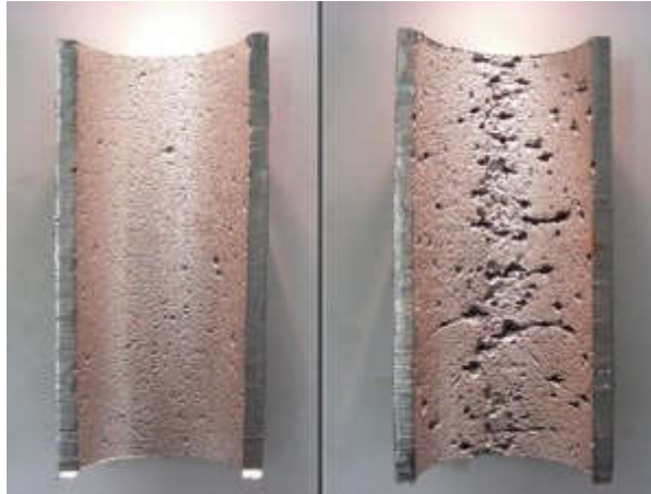
Gambar 2. Korosi Pada Pipa Boiler (Onny,2013)
