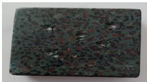
Gambar 4. spesimen 40% sampah plastik 60% cangkang sawit 2 mm
