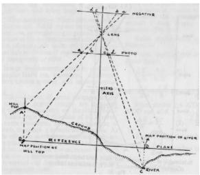
Gambar 1 Ilustrasi Relief Displacement
