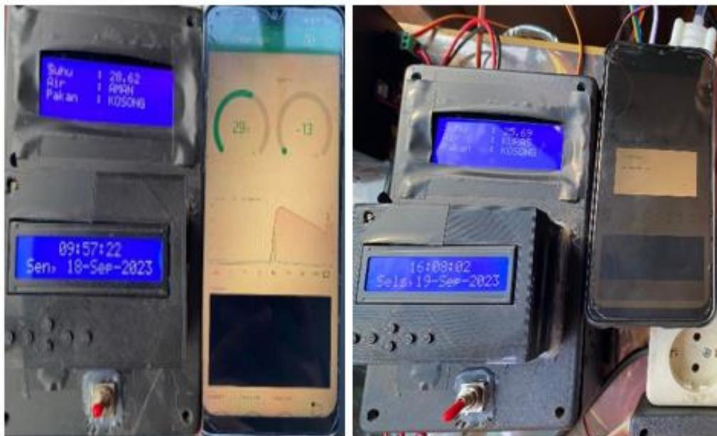
**Gambar 4. Simulasi Pengujian Sesor Kekeruhan Air dan Sensor Suhu**
